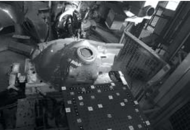
▲ Использование доски с фотометрическими метками для определения внешней ориентации камер
