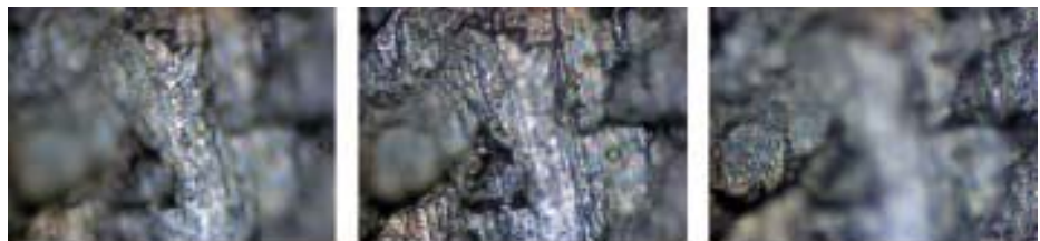
▼ Восстановление 3D-профиля листа металла, наблюдаемого с помощью микроскопа, методом «глубина из фокусировки»
