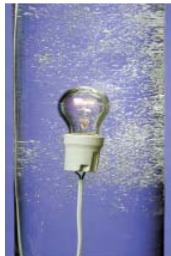
РИС. 3. ► 3A Novec 1230 не проводит электричество
