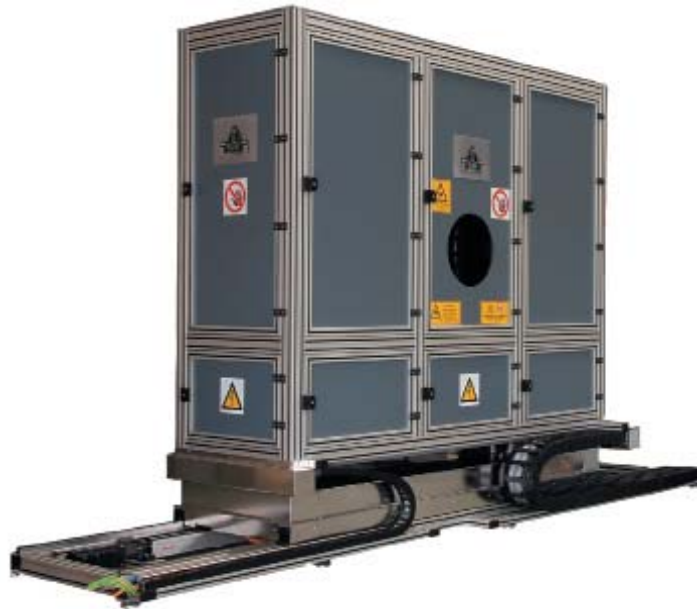
◀ Кожух с камерами имеет габариты (Д×Ш×В) 5×1×3 м. Он выполнен на основе алюминиевого каркаса и весит около 5 т
